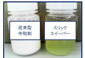
マシン油(VG46)と水の混合液に従来型中和剤と本製品を各同量添加し攪拌した状態。
