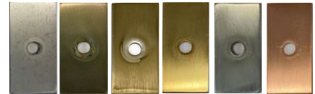
長期間使用したクーラント+クーラントレイズ添加 材質は左から、アルミ・鋳鉄・鋼・黄銅・はんだ・銅 試験方法は金属腐食試験(JIS K2234:2018)に準ずる
